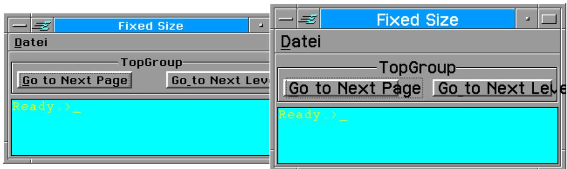
Diese Bilder demonstrieren die Wirkung einer festen Größe in Pixel für die oberen Buttons. Im rechten Bild wurde eine vergrößerte Systemschrift verwendet.
