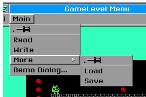
Die Menü-Einträge sind die Children eines Menüs. In vielen Fällen sind dies Buttons. Verschachtelte Menüs (Sub-Menüs, siehe Bild) erhalten Sie, wenn sie andere Menüs als Menü-Einträge verwenden. Verwenden Sie Dialoge als Menü-Einträge erzeugt das System selbstständig einen Button im Menü, der den Dialog öffnet. Sie dürfen jedoch auch beliebige andere Objekte, etwa Groups oder Listen-Objekte als Children von Menüs verwenden.
