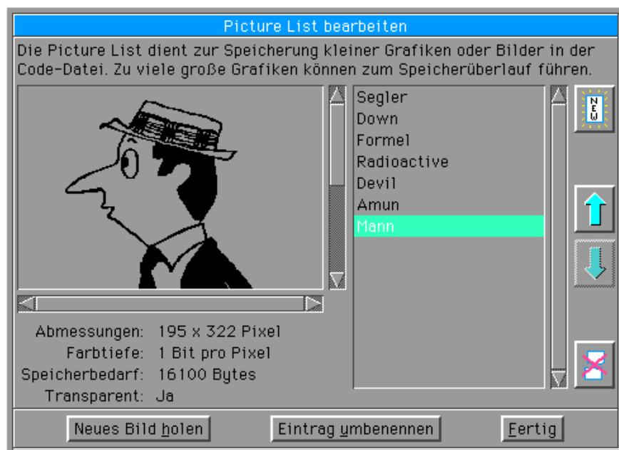
Die Picture-List ist eine komfortable Möglichkeit Grafiken im der Codedatei selbst unterzubringen und sie zur Laufzeit zu zeichnen. Beim Erstellen Ihres Programms laden Sie über das R-BASIC Menü "Extras" - "Picture-List" Bilder aus einer externen Quelle in die Picture-List. Die Bilder werden dann über ihren Namen angesprochen. Sie können diese Bilder mit dem Befehl **DrawPicture** auf den
