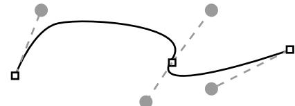
Rechtes Bild: Zwei Kurvensegmente und die dazugehörigen Kontrollpunkte. Für diese Figur müssen 7 Punkte an BezierSpline übergeben werden.
